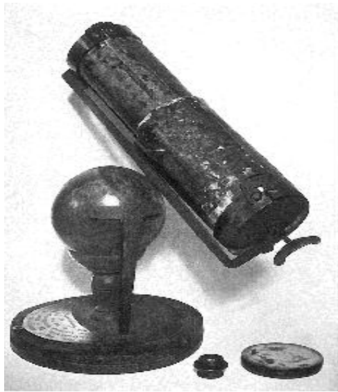
Fig. I.4. Il primo telescopio riflettore di Newton (1668).
